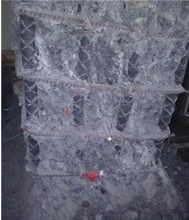
圖 50 試體實際縱向鋼筋挫屈
